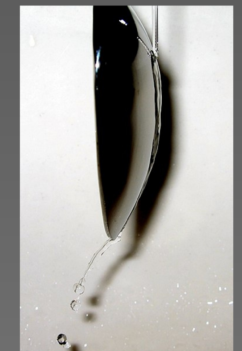
Ejemplo de efecto Coanda sobre una cuchara.
